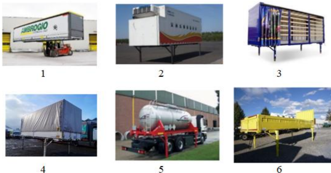
Рисунок 2.2 - Можливі варіації змінних кузовів (1 – 1А; 2 – В; 3 – 1С із фіранками; 4 – з тентом; 5 – цистерна; 6 – з відкидними бортами)
