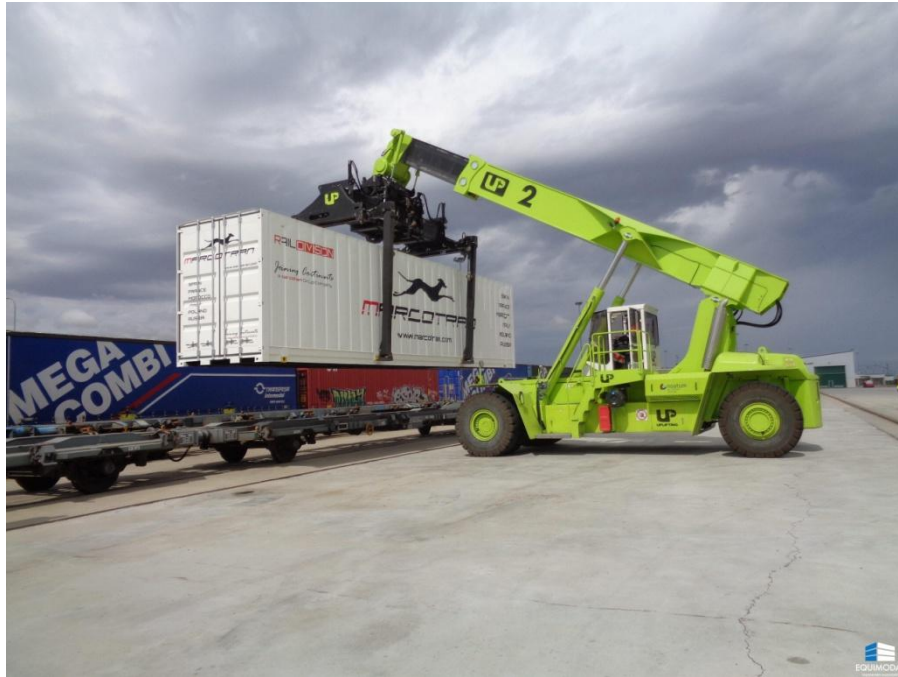
Рисунок 2.6 - Завантаження змінного контейнера на залізничну платформу з використанням зачіпних виступів
