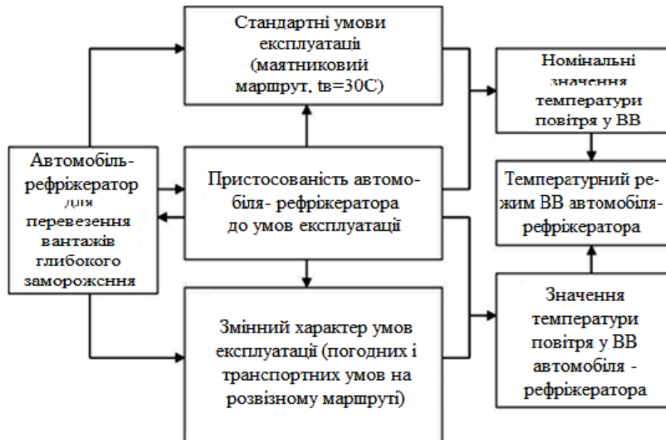
Рисунок 3.3 - Схема формування температурного режиму ВВ автомобіля-рефрижератора
