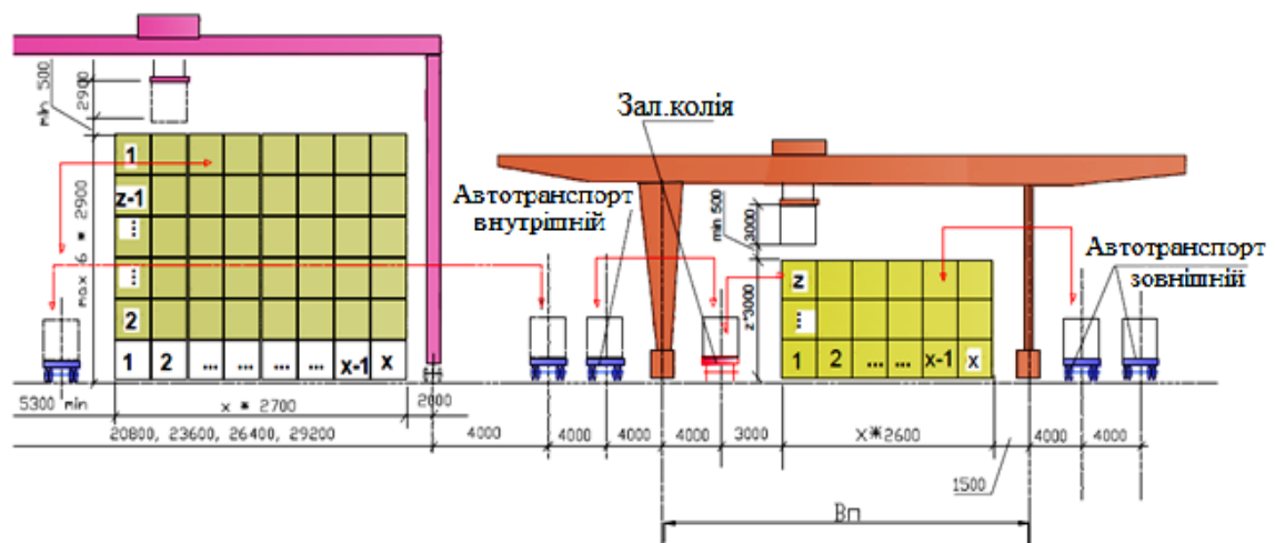
Рисунок 2.7 - Контейнерний термінал з козловим рейковим краном (RMG) і порталним пневмоколісним краном ППК (RTG)
