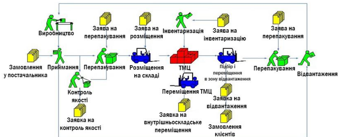
Рисунок 1.1 - Система комплектації замовлення
