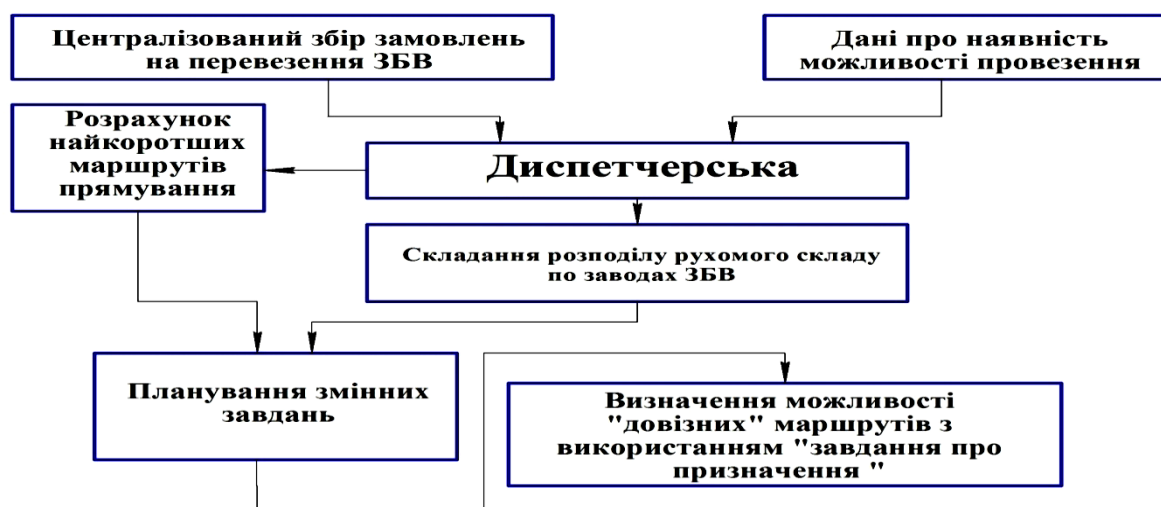
Рис.1.1. Схема оперативного планування перевезень
