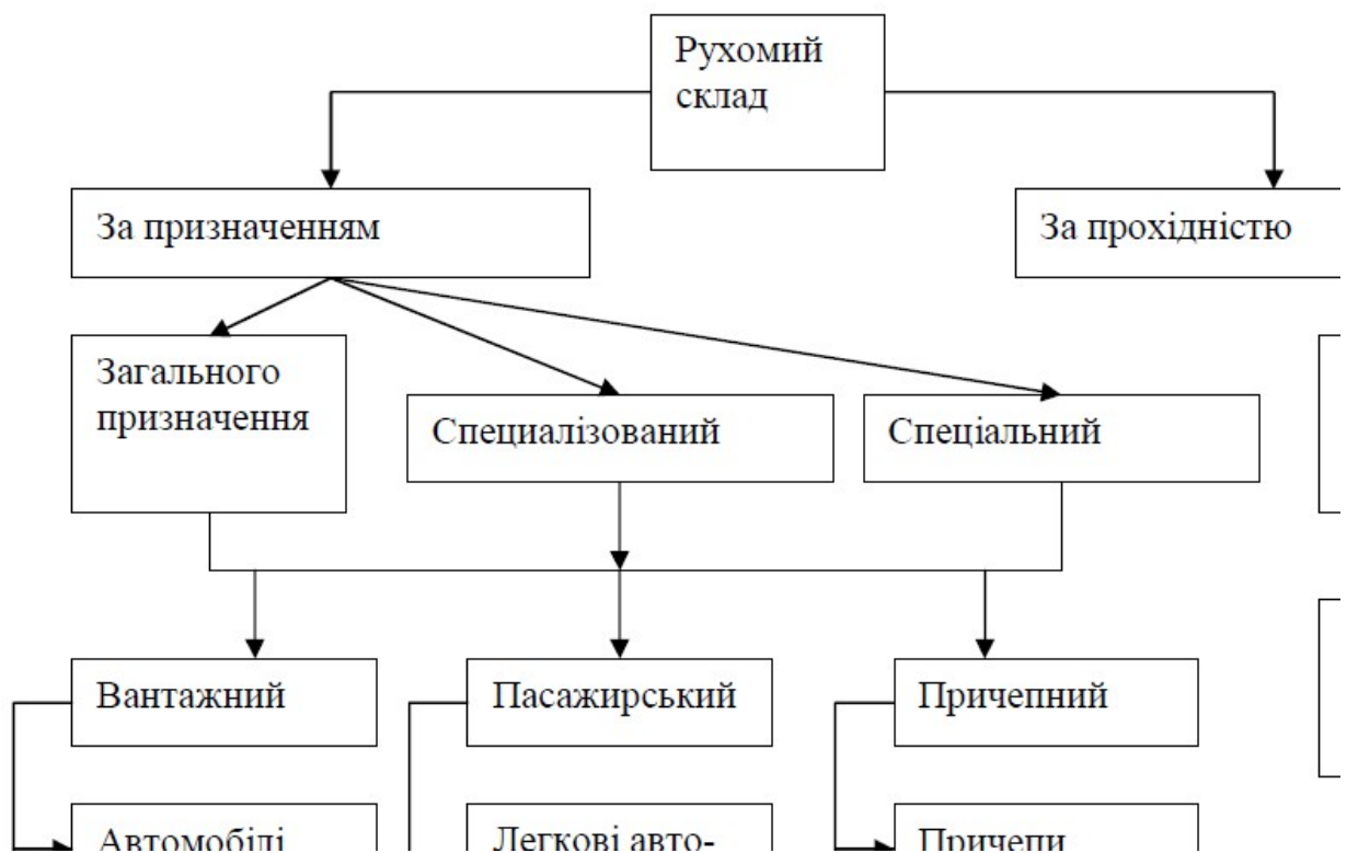
Рис. А.1 Класифікація типів рухомого складу автомобільного транспорту за призначенням і прохідності
