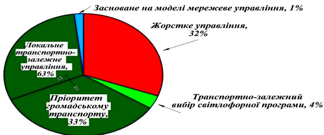
Рис.1.3. Застосовувані сьогодні в Німеччині методи управління на регульованих перехрестях і пішохідних переходах обладнаних світлофорами
