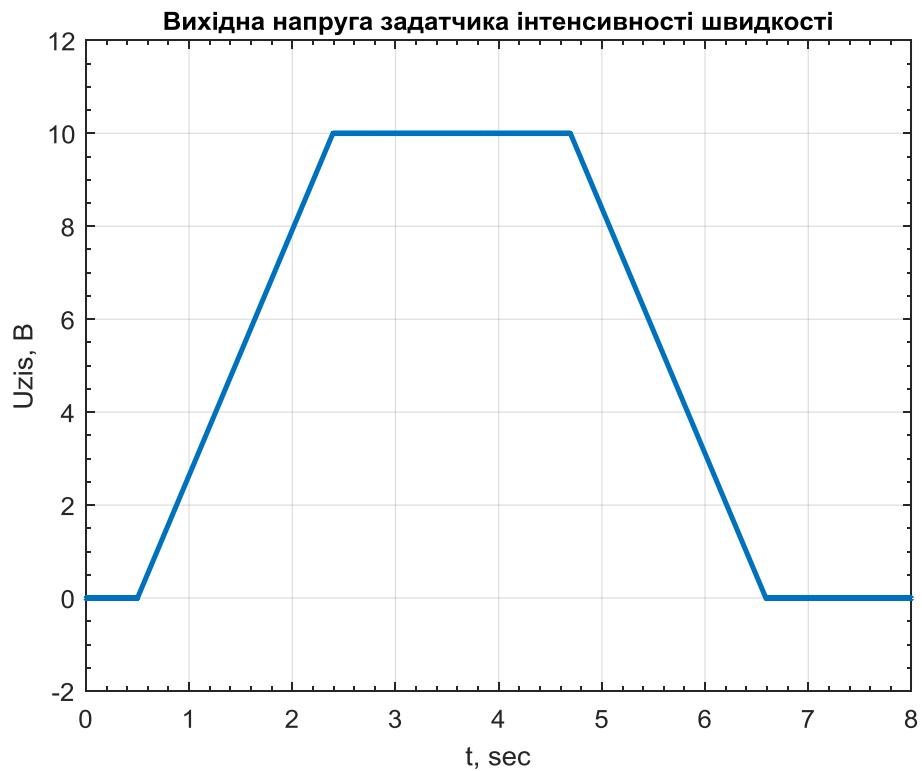
Рисунок 5.6 - Графік перехідного процесу напруги задатчика інтенсивності швидкості при номінальних параметрах
