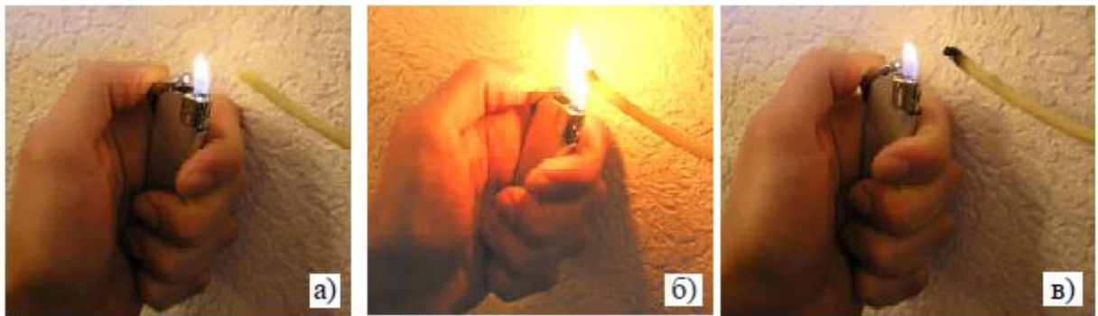
Рисунок 6.4 – Дія полум'я на компонент (ізоляційну оболонку), що не підтримує горіння:
