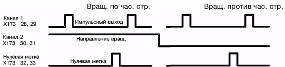
Рисунок 3.4— Датчик швидкості з одним виходом для напрямку обертання
