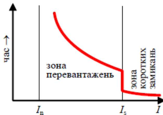
Рисунок 7.6 – Часо-струмова характеристика відмикача ( I – очікуваний струм у колі, rms)
