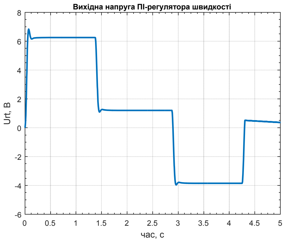
Рисунок 5.7 - Графік перехідного процесу напруги ПІ-регулятора швидкості ( I_c = 0,3I_H )
