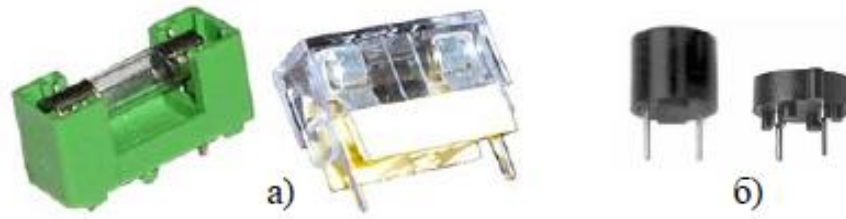
Рисунок 7.13 – Деякі конструкції мініатюрних запобіжників (а) та субмініатюрних вставок (б)
