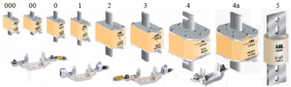
Рисунок 7.8 – Сучасні європейські запобіжники промислового призначення системи NH: вставки типорозмірів 000, 00, ... , 4a, 5 та ізоляційні основи з терміналами різних виконань (знизу) та різними можливостями приєднання зовнішніх провідників
