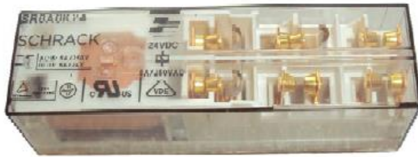
Рисунок 6.4 – Електромагнітне реле, яке забезпечує гальванічне розділення кіл, але не задовольняє вимогам щодо функції роз'єднання
