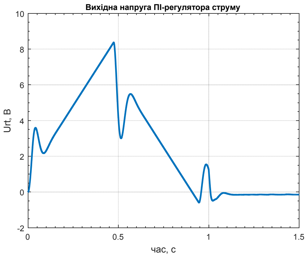
Рисунок 5.13 - Графік перехідного процесу напруги ПІ-регулятора струму I_c = 0,2I_H
