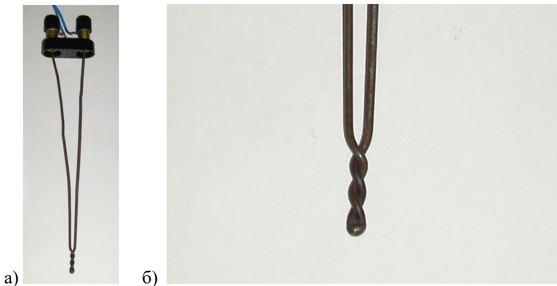
Рис.1.10 - Проста конструкція термопари (а); вид контакту термопари (б)
