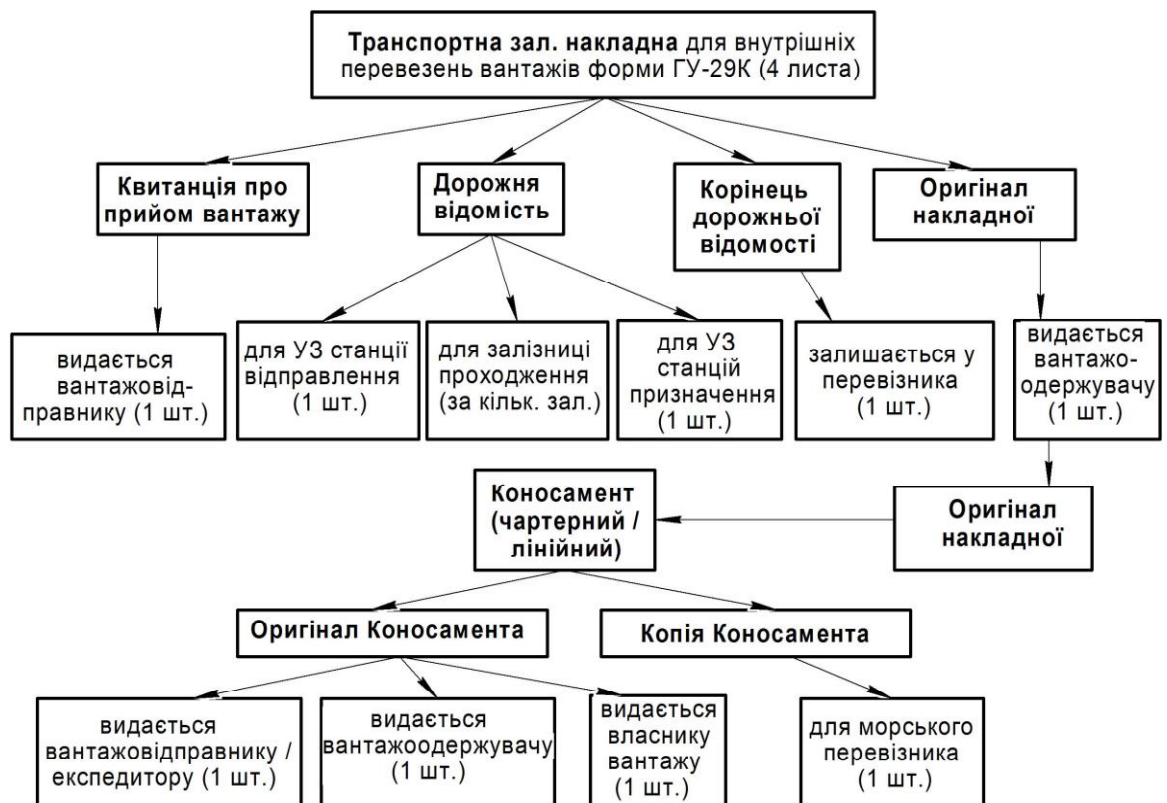
Рис. 3.1 Документообіг при перевезеннях зовнішньоторговельних вантажів в контейнерах в непряму міжнародному залізнично-водному сполученні
