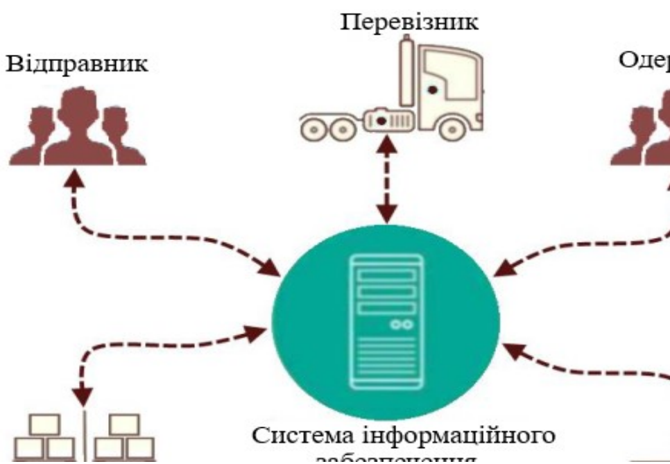
Рис. 1.2 Схематичне зображення руху інформаційних потоків всередині системи інформаційного забезпечення (схема актуальна для учасників перевезення вантажів)
