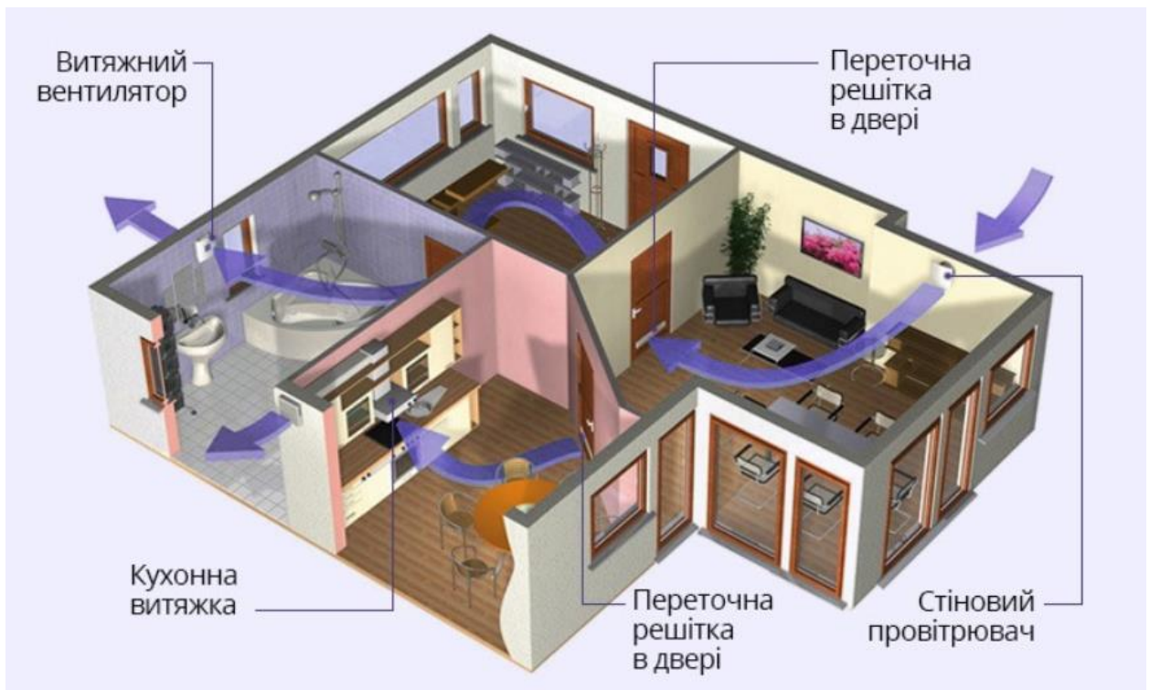
Рисунок 1.3 - Організація припливно-витяжної вентиляції в квартирі
