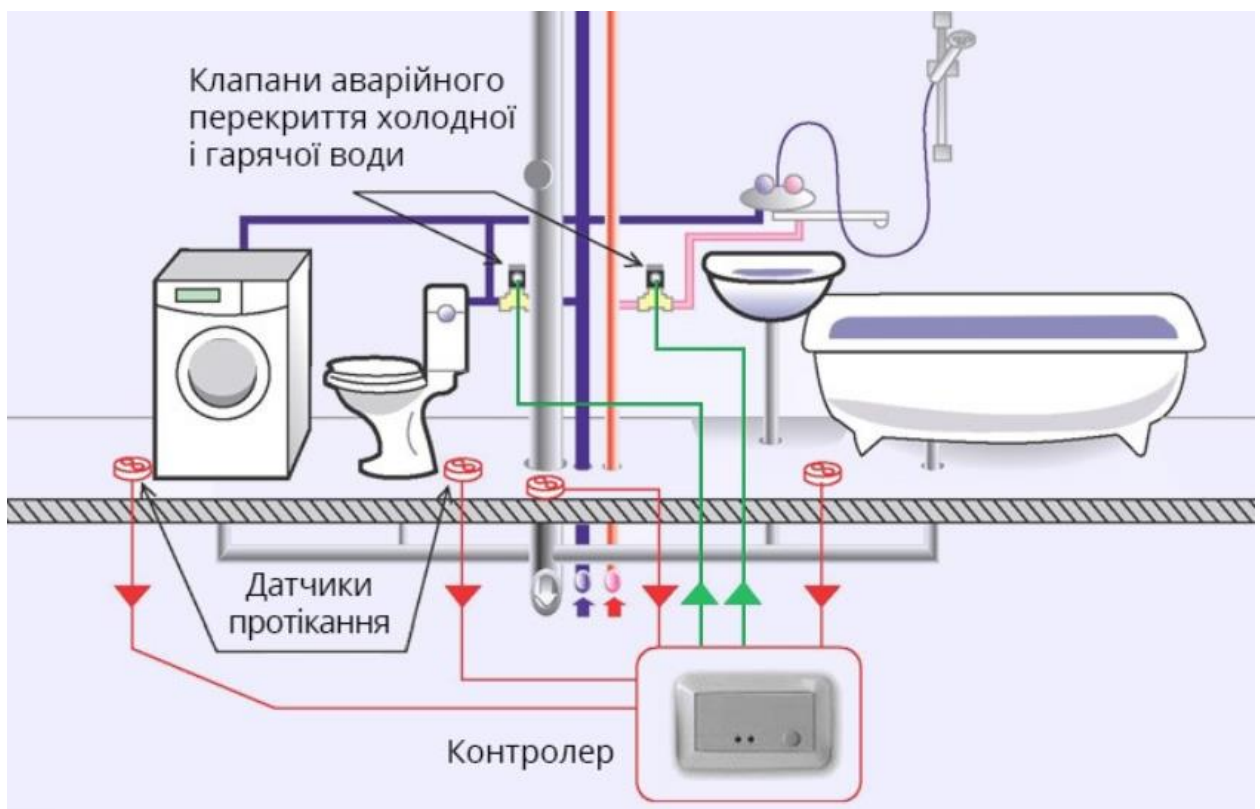
Рисунок 1.11 - Схема розміщення комплектуючих системи захисту від протікання
