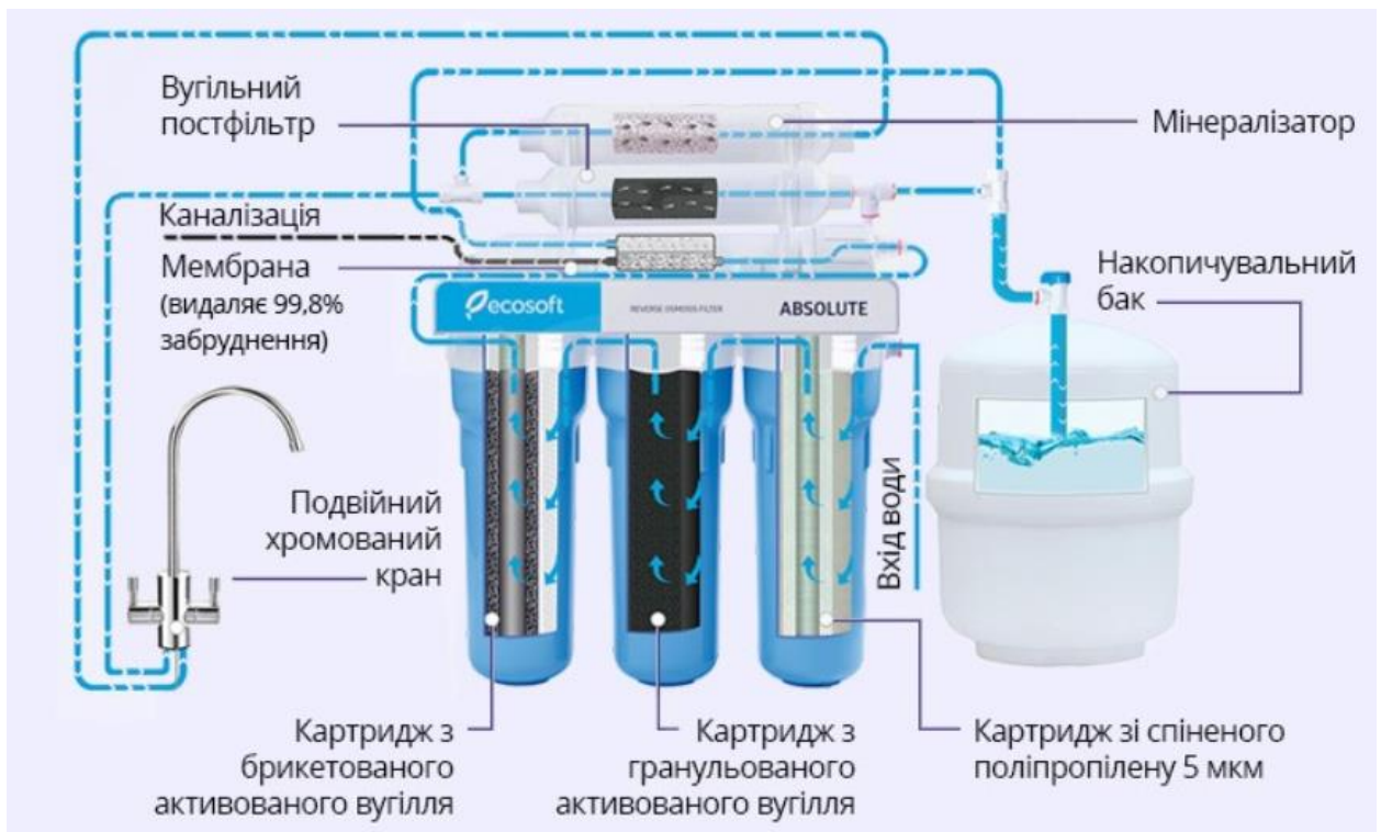
Рисунок 1.10 - Будова зворотньоосмотичного фільтра Ecosoft Absolute MO650MECO з мінералізатором
