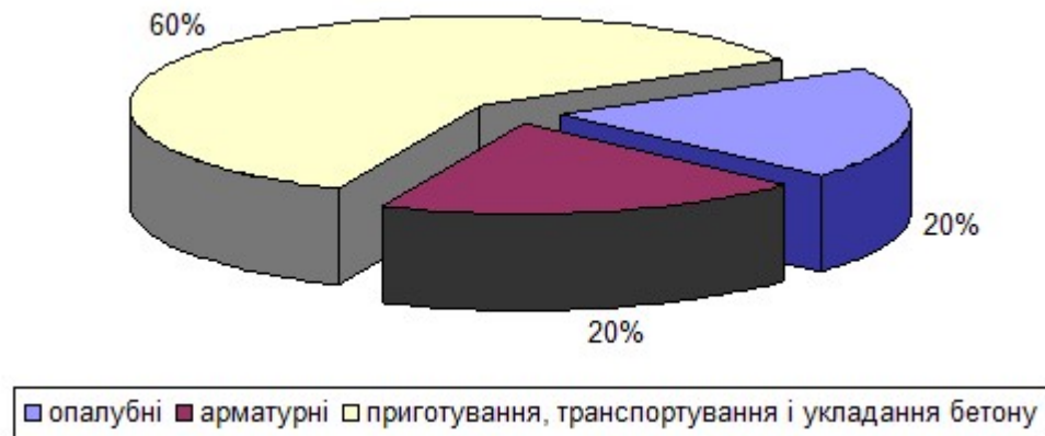
Рисунок 1.14 – Витрати робочого часу в монолітному будівництві складають на роботи: опалубні – 20%; арматурні – 20%; приготування, транспортування і укладання бетону – 60%
