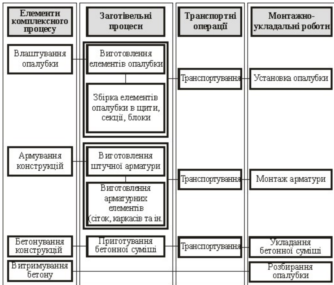
Рисунок 1.15 – Структурна схема комплексного процесу зведення монолітних залізобетонних конструкцій з ненапруженою арматурою
