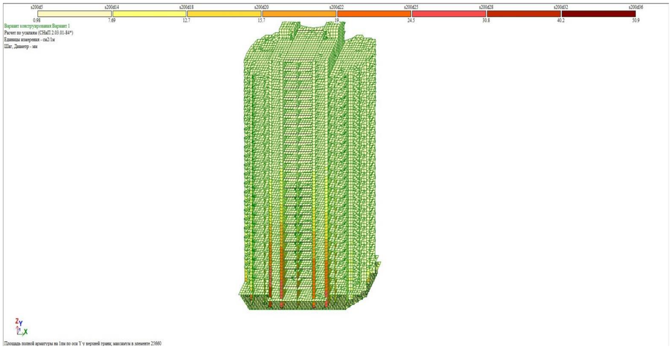
Рис. 3.4 Армування верхньої частини пластинчатих елементів у напрямку осі OY усїєї будівлі
