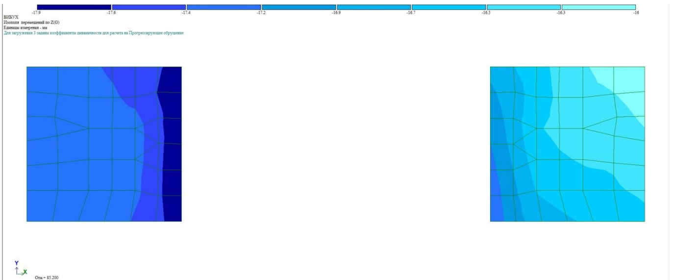
Рис. 4.9 Деформації (прогини) плити перекриття спорудження над ліфтовою шахтою
