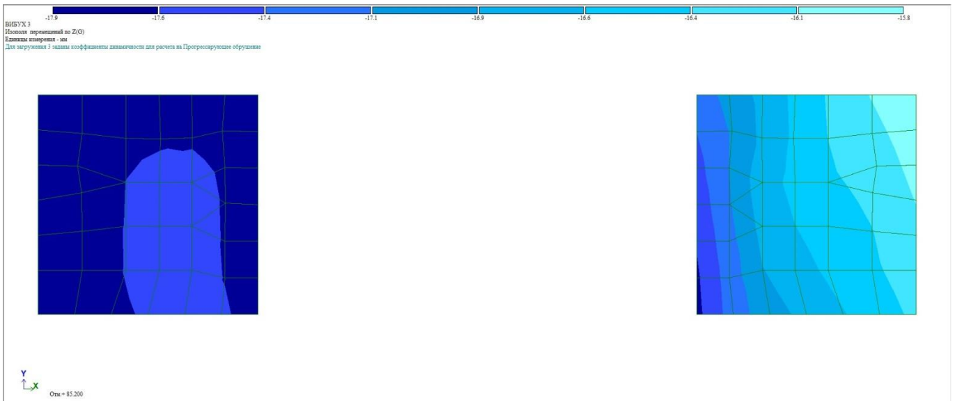
Рис. 4.20 Деформації (прогини) плити перекриття спорудження над ліфтовою шахтою
