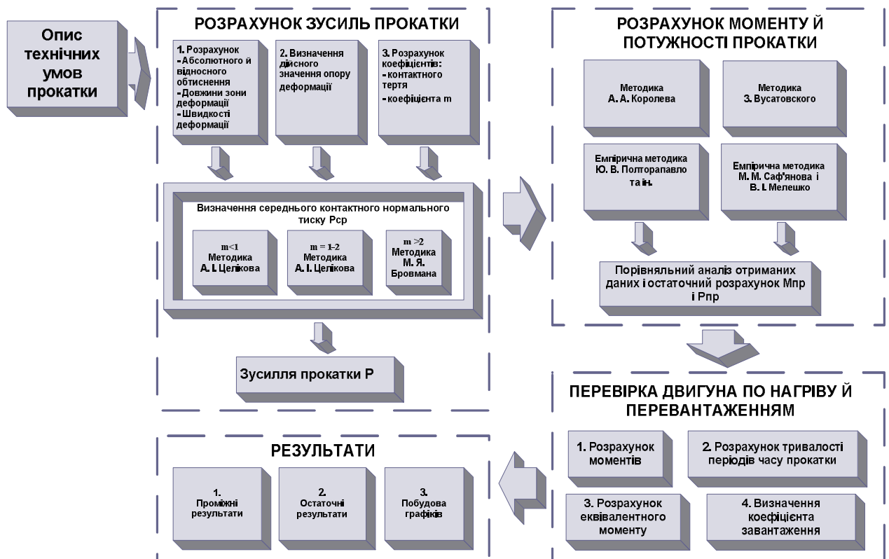
Рисунок 6.4 – Загальна схема побудови розрахункового алгоритму енергосилових параметрів листопркатного стану
