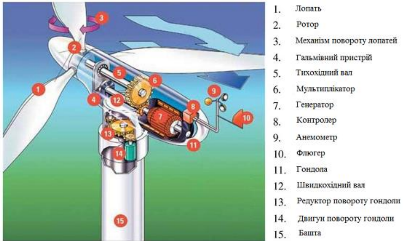
Рисунок 2.6 – Улаштування вітрогенератора
