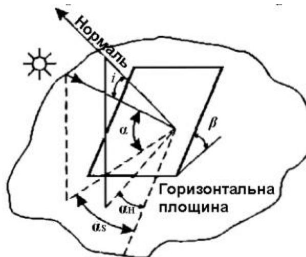
Рисунок 1.3 – Кути, які характеризують положення точки на похилій поверхні відносно напрямку сонячних променів
