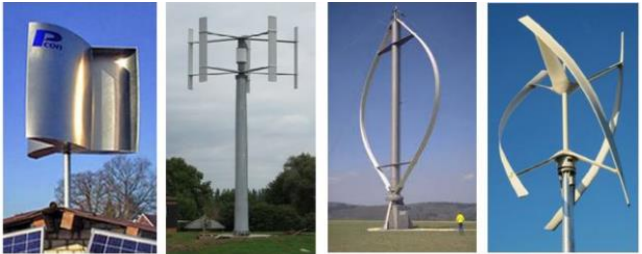
Рисунок 2.3 – ВЕУ з вертикальною віссю обертання:
