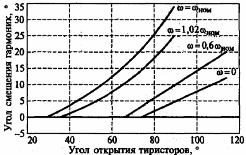
Рисунок 1.17 - Залежність кута зсуву від кута відкриття тиристорів для двигуна типу 4A200L6
