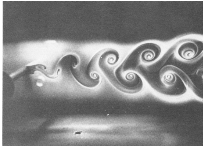
Рисунок 1.2 – Схема вихроутворення за проводом (а) та вид збоку (б) на вихрі, що зриваються з нерухомого циліндра ( Re = 200 , частота зриву вихрів f = 28 Гц)
