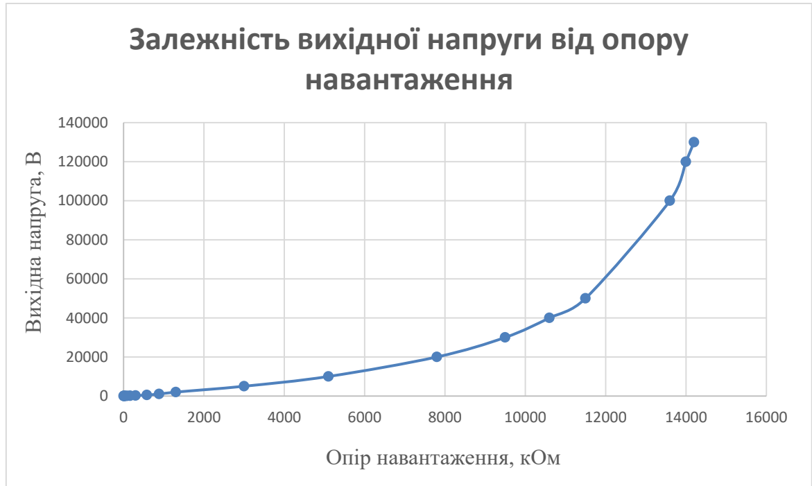
Рисунок 4.15 - Графік залежності вихідної напруги від опору навантаження
