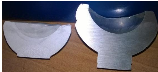
Рисунок 3.6 – Поковки зі сплаву АД-0 у розрізі:
