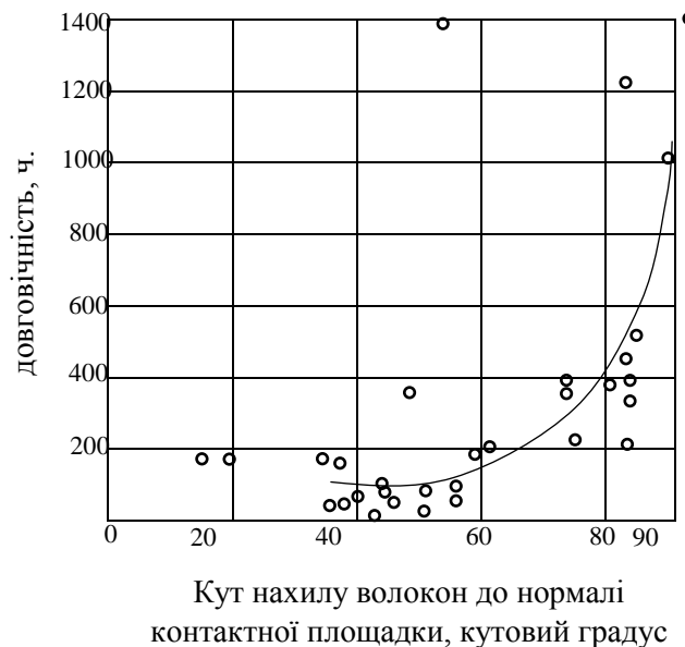
Рисунок 1.1 – Залежність довговічності підшипника від кута між напрямком розташування волокон та нормаллю до контактної площадки у зоні максимальних напруг
