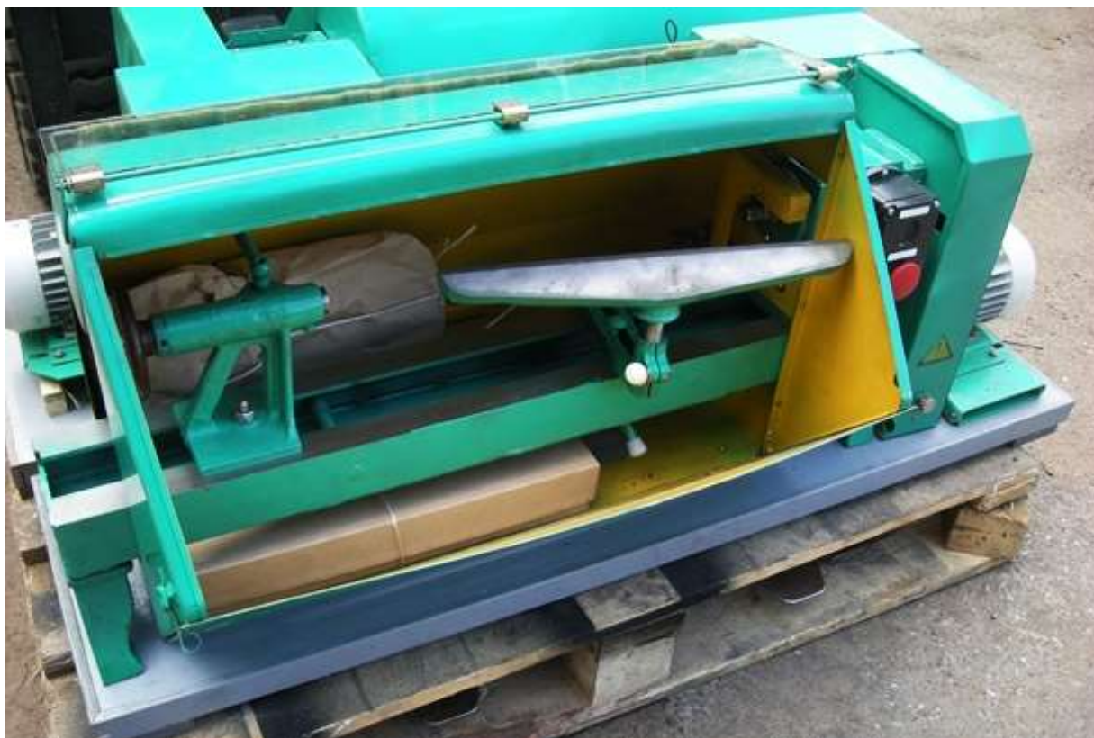
Рис. 1. Зовнішній вигляд токарного верстату СТД-20М
