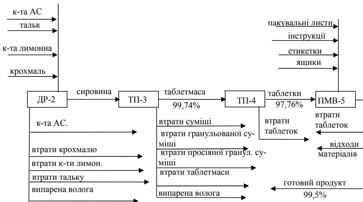
Рисунок 7.1 – Схема матеріальних потоків виробництва таблеток «Кислота ацетилсаліцилова»
