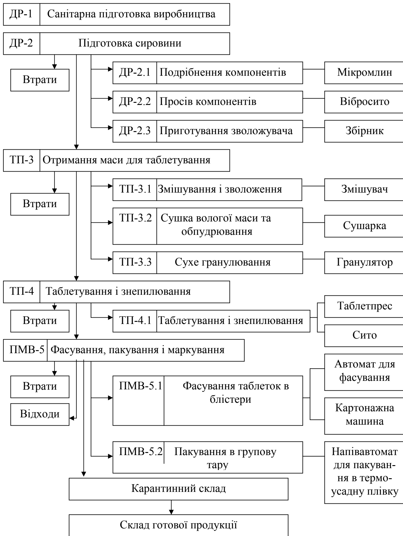
Рисунок 6.1 – Блок-схема виробництва таблеток „Астемизол” 0,01 № 10
