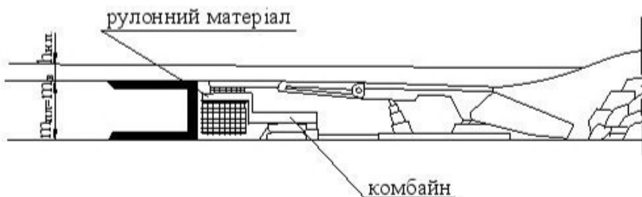
Рисунок 3.1 - Затяжка покрівлі рулонним матеріалом
