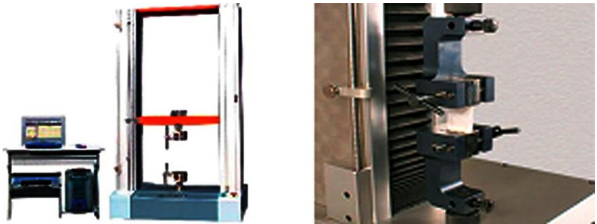
Рис. 3.1. Установка Electronic Universal Testing Machine Measuring Control Software: а) - зовнішній вигляд; б) зразок, заправлений у верхній та нижній затиски перед початком досліджень
