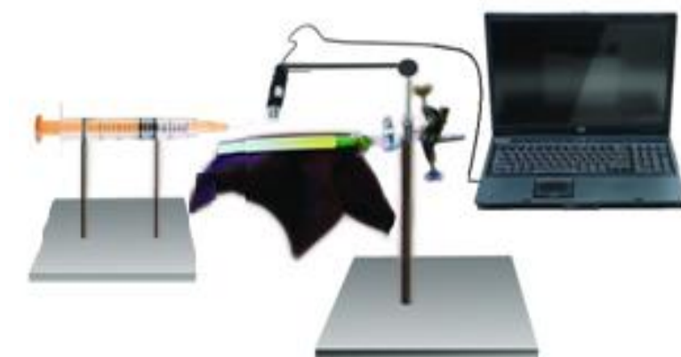
Рис. 2.8. Розроблена установка для визначення горизонтального змочування текстильних матеріалів
