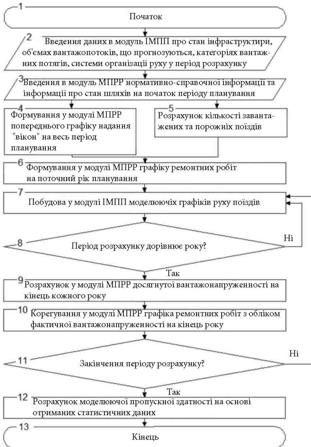
Рис. 3.1 – Загальна блок-схема програмного комплексу імітаційного моделювання пропуску поїздів по реконструйованій лінії, що ілюструє взаємодію двох основних модулів: модуля імітаційного моделювання процесів перевезень (ІМПП) і модуля планування ремонтних робіт (МПРР)
