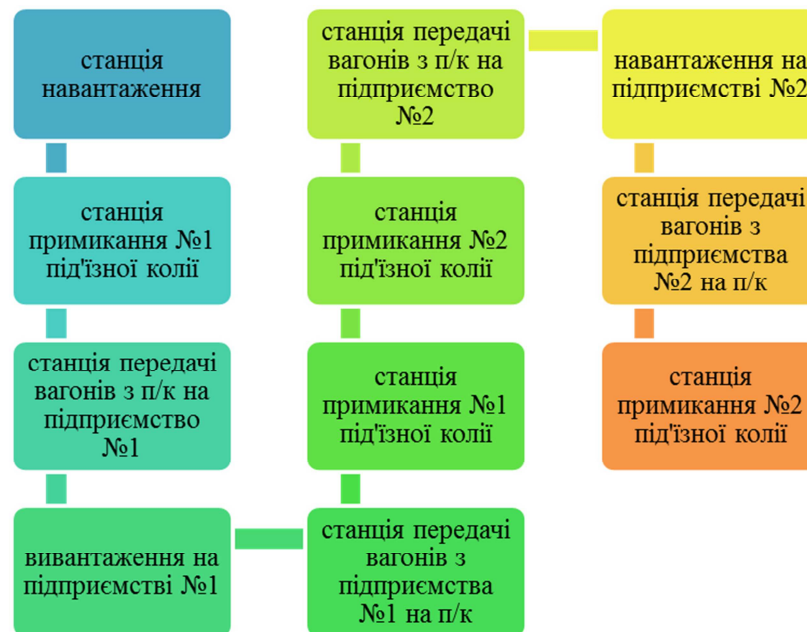
Рис. 3.2. Схема обігу вагону при існуючій технології роботи станцій примикання та під'їзної колії ППЗТ
