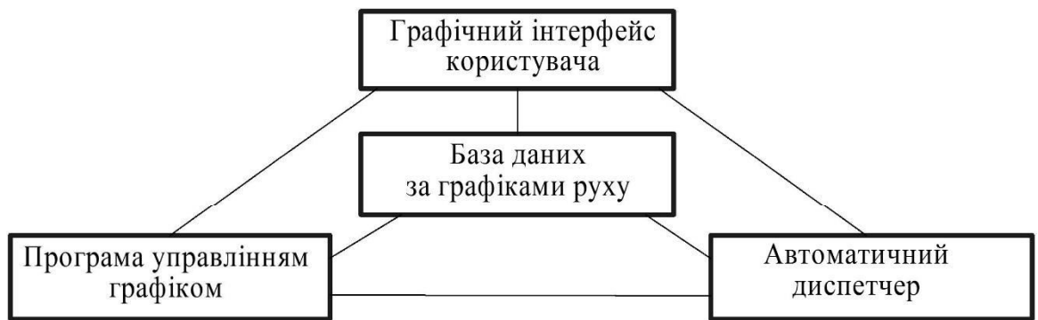
Рис.3.5. Компоненти системи диспетчерського управління рухом поїздів
