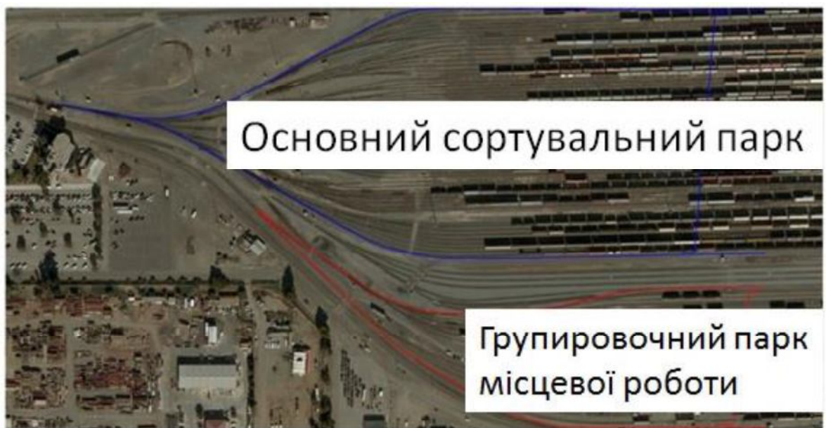
Рисунок 1.2 - Розташування основного сортувального і групировочного парків на станції Вест-Колтон (США)
