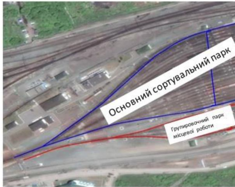
Рисунок 1.3 - Розташування основного сортувального парку і сортувально-групірочних шляхів на станції
