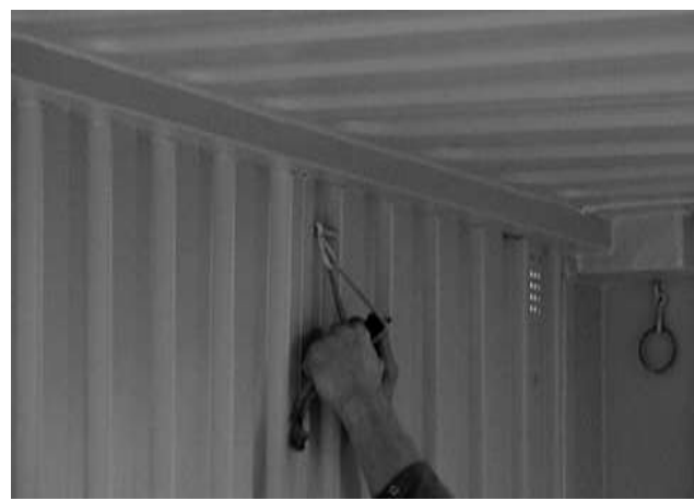
4. Підготовка кріпильних елементів контейнера
