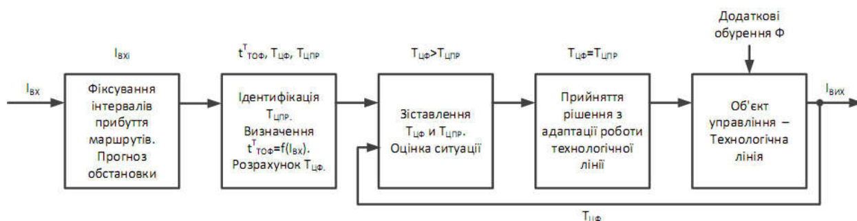
Рис. 3.3 Функціональна схема логістичного управління роботою технологічної лінії
