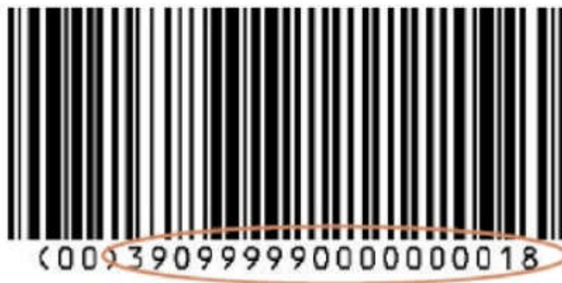
Рис. 2.14. Вид логістичної одиниці серійного коду контейнера або SSCC за стандартом GS1 (джерело: GS1)
