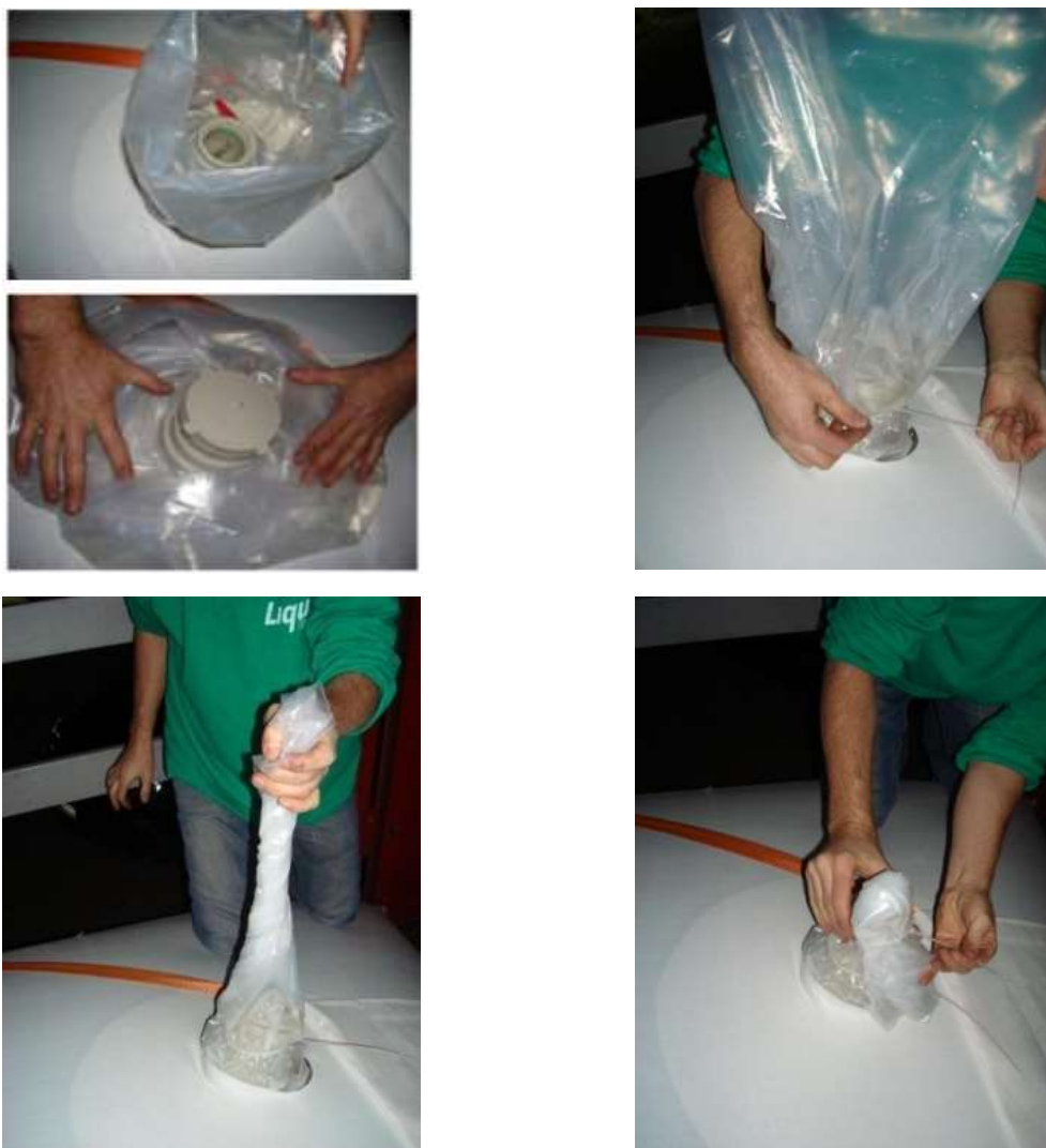
Рисунок 5.12 - Закручування горловини ФТ
