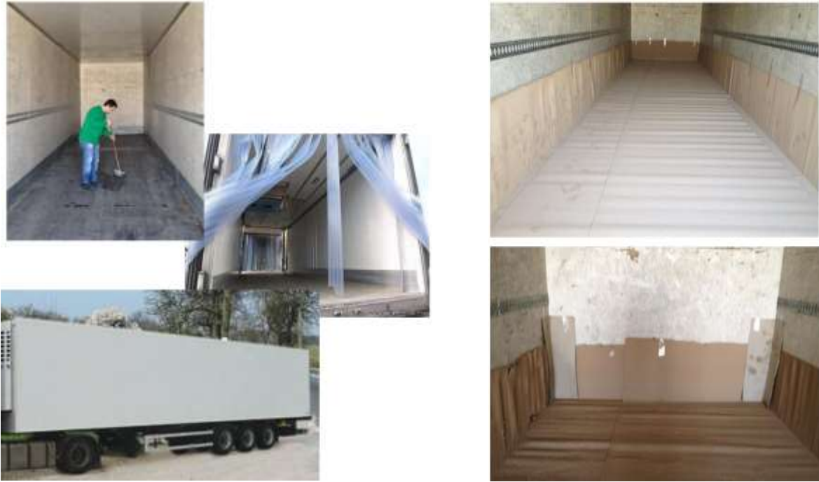
Рисунок 5.7 – Підготовка вантажного приміщення під установку ФТ
