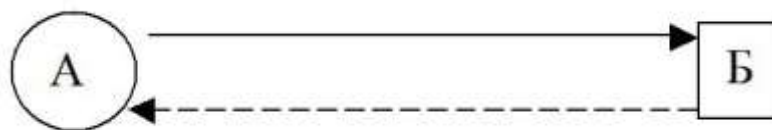
Рисунок 5.13 - Схема руху РС на маятниковому маршруті з порожнім зворотним пробігом
