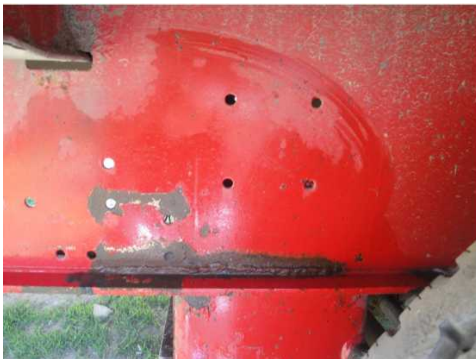
Рис. 1.17. Вид втомної тріщини рами напівпричепа, яка усунена зварюванням
