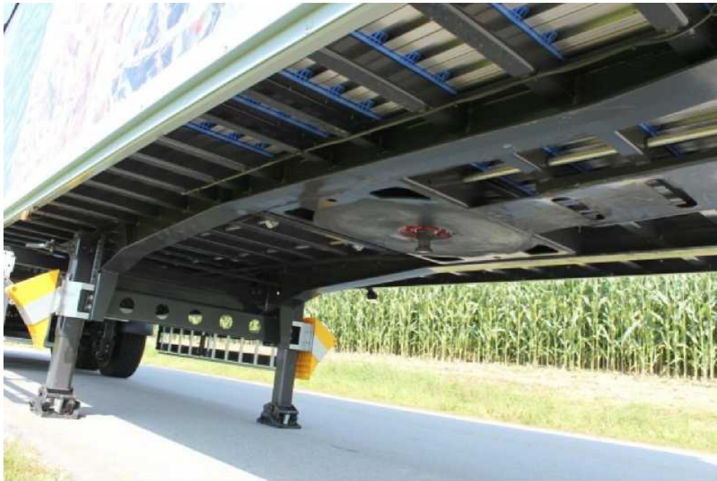
Рис. 1.8. Вид рами напівпричепа
