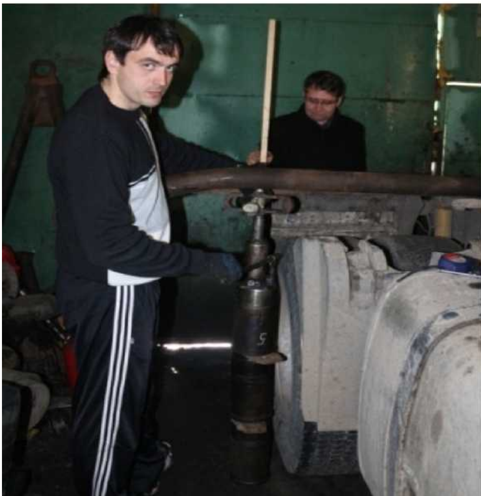
Рис. 3.2. Вимірювання параметрів кутової жорсткості тягача «Мерседес» за допомогою балки і домкрата
