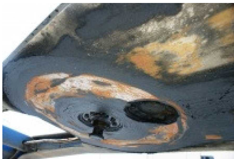
Рис. 1.9. Опорна плита напівпричепа з двома гніздами для установки зчіпного шворня для двовісного і тривісного сідельного тягача
