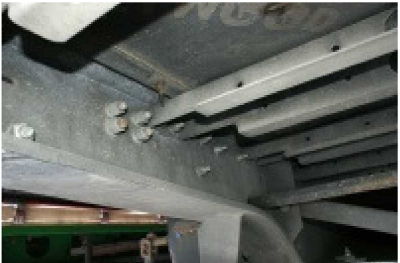
Рис. 1.12. Вид на поперечки, прикручені болтами до лонжеронів
