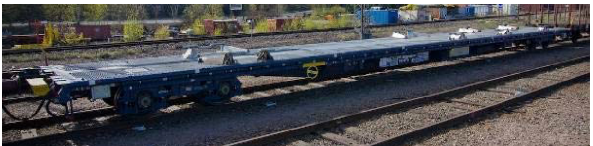
Рис. 5.7. Вагон Sdggngqss-w має довжину завантаження 24,8 м
