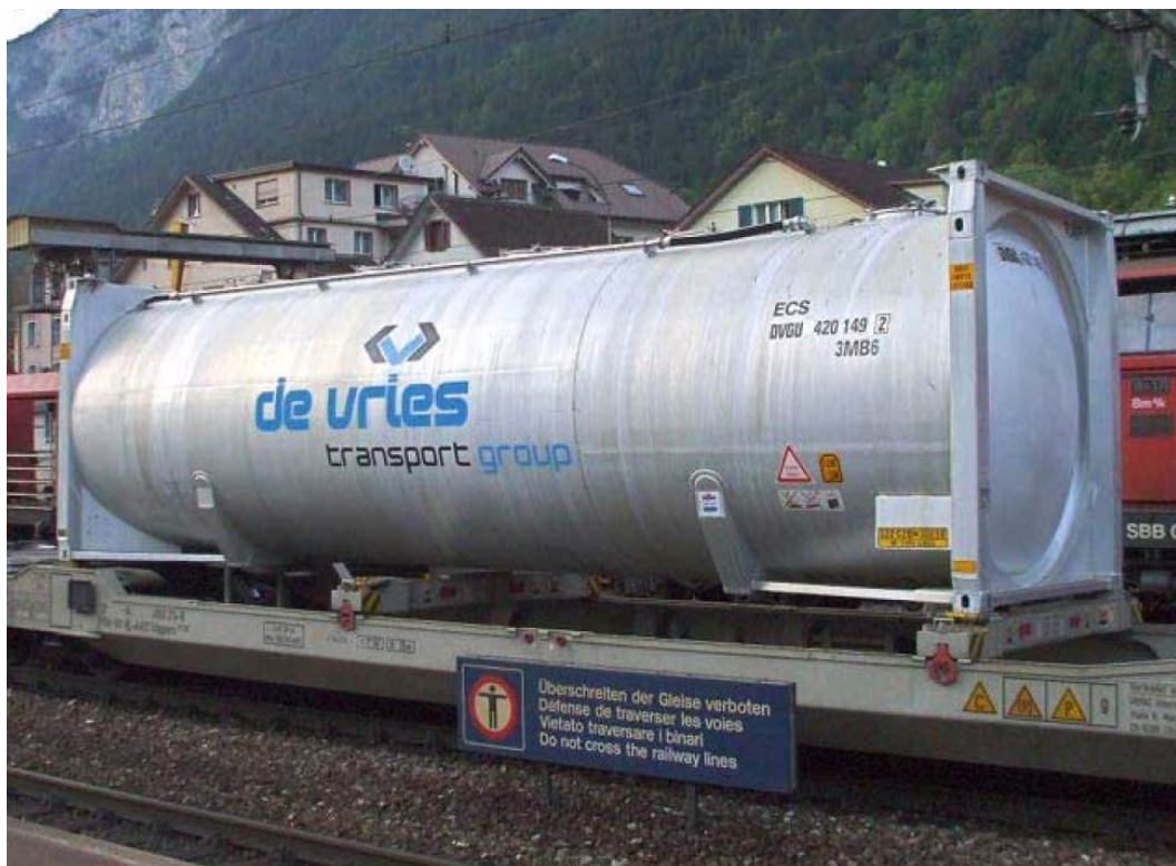
Рис. 5.20. Перевезення контейнера-цистерни на платформі
