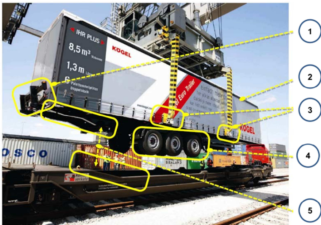
Рисунок 1.8 - Конструктивні особливості напівпричепи, придатного для вертикального перевантаження: 1 - відкидний протипідкатний буфер; 2 - посилене кріплення даху; 3 - отвори для кліщових захватів, окантовка тенту навколо отворів, посилена рама; 4 - певне положення візка на рамі; 5 - профіль рами, відповідний профілю вагона
