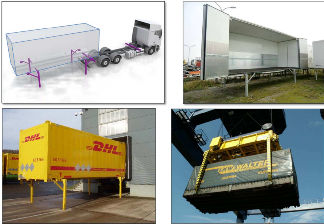
Рисунок 1.7 - Знімні кузови. Установка на шасі автомобіля (угорі ліворуч); ЗК з розкривається бічною стінкою (вгорі праворуч); обробка ЗК на складі (внизу зліва); перевантаження на ынтермодальному терміналі (внизу праворуч) [5, 14]
