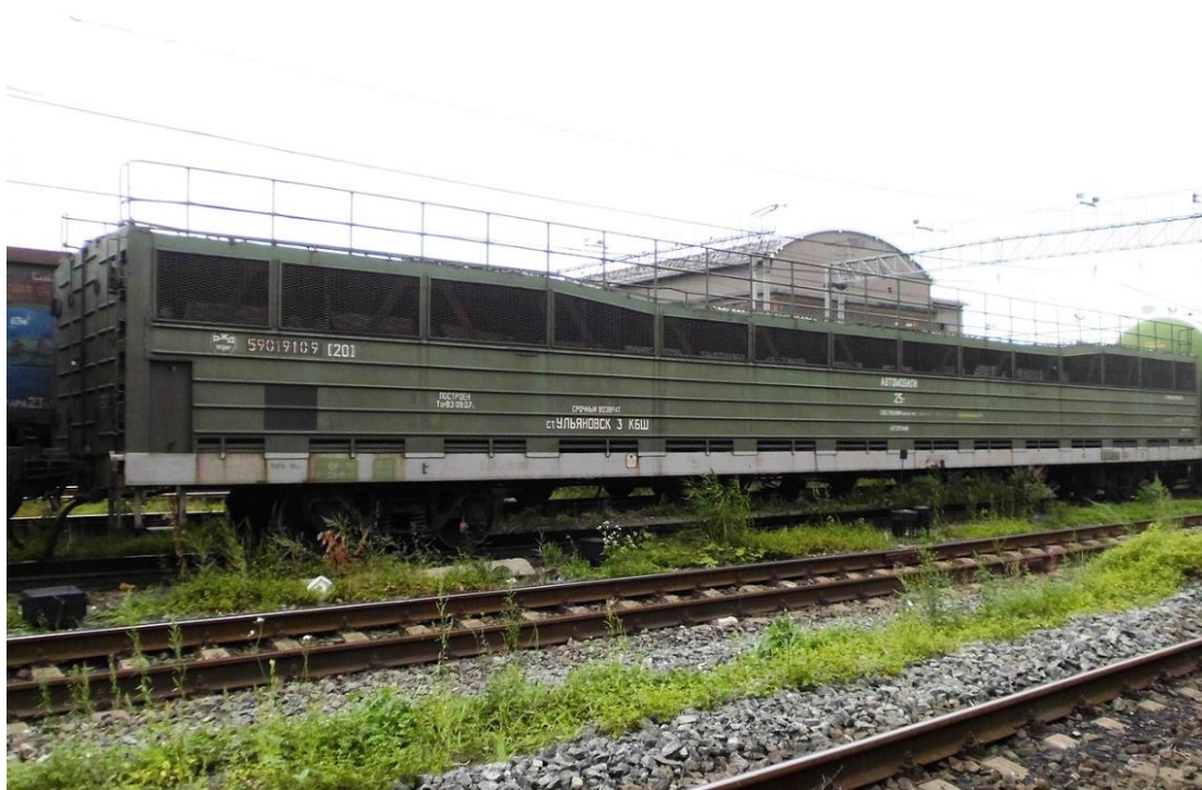
Рисунок 2.5 - Двох'ярусна платформа для перевезення автомобілів із закритим нижнім і відкритим верхнім ярусом, модель 13-9752
