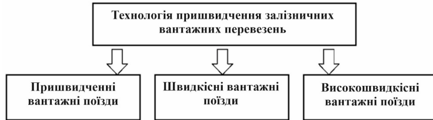
Рис. 2.1. Варіанти реалізації технології прискорення залізничних вантажних перевезень.
