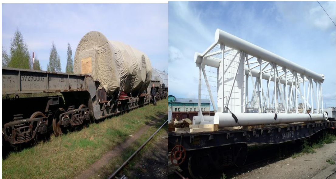
Рис. 1.3- Перевезення негабаритних вантажів (техніки, металевих конструкцій)
