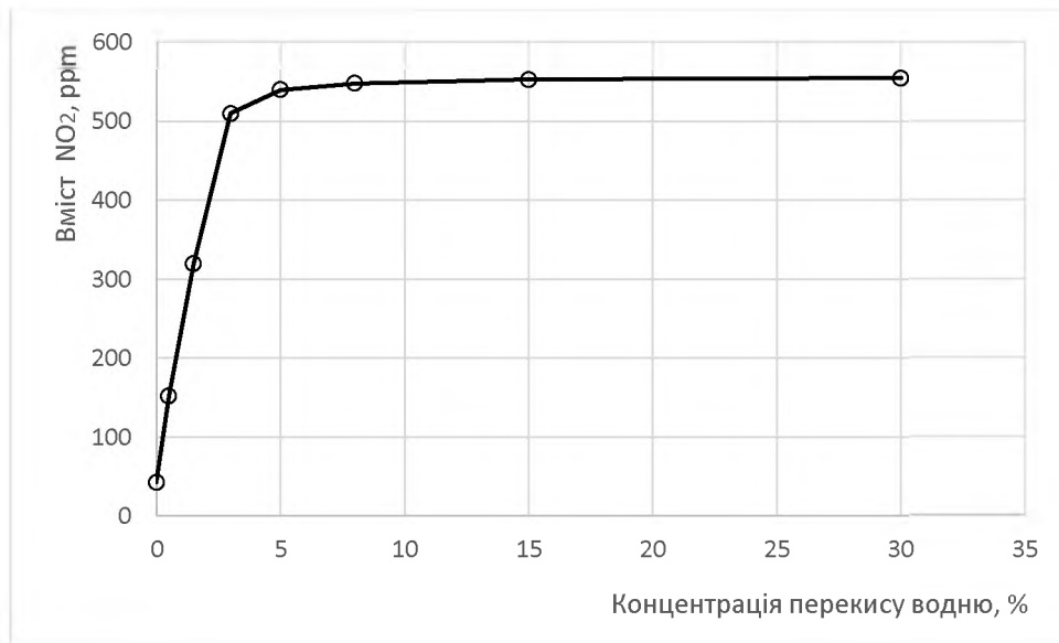
Рис. 4.2. Вплив концентрації перекису водню в реакційному середовищі на концентрацію NO 2 в газі, що виходить з реактора
