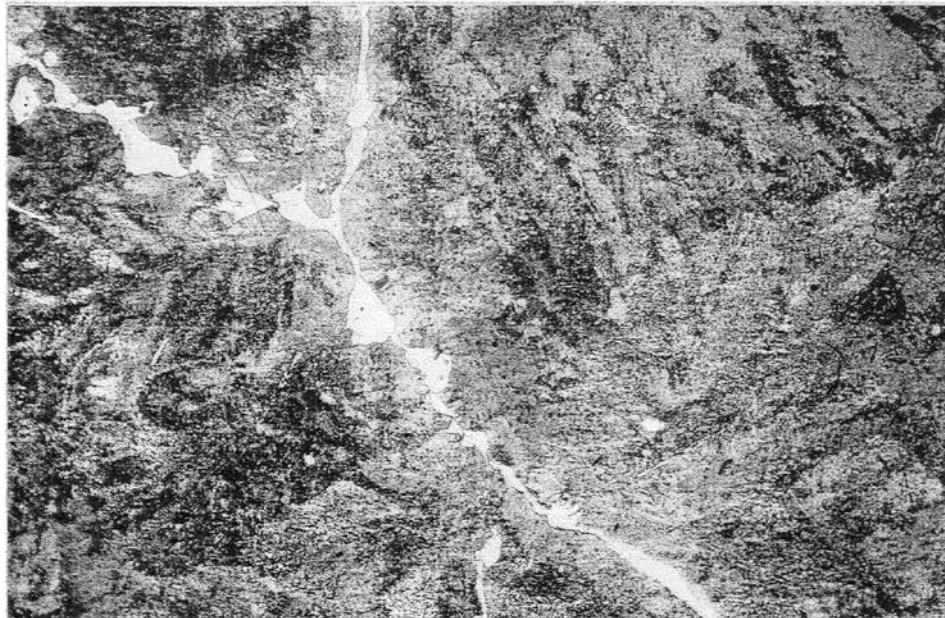
Рис. 1.4. Крупнозерниста структура литої колісній сталі.
