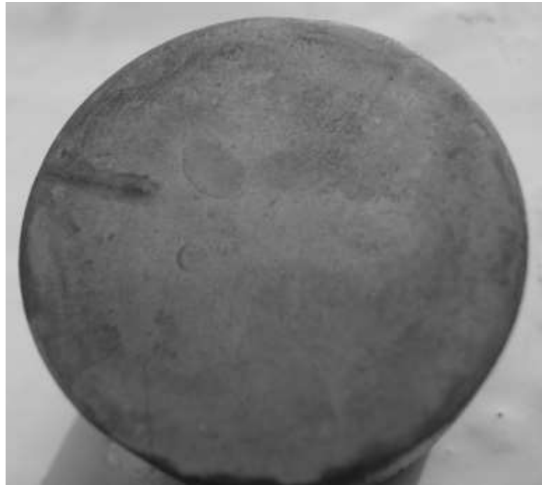
Рис. 5.5. Вид тріщини на пружині після травлення у реактиві Гейна
