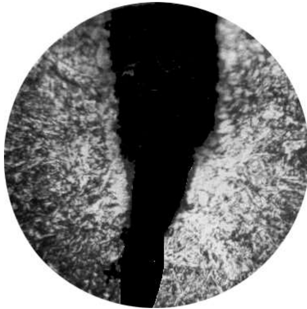
Рис. 5.8. Знеуглецьований шар у краю тріщини на пружині ( \times 250 )
