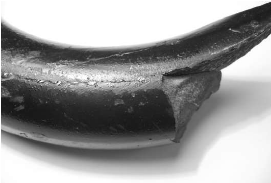
Рис. 5.1. Утворення зламу від волосоподібної тріщини на поверхні витка пружини:
